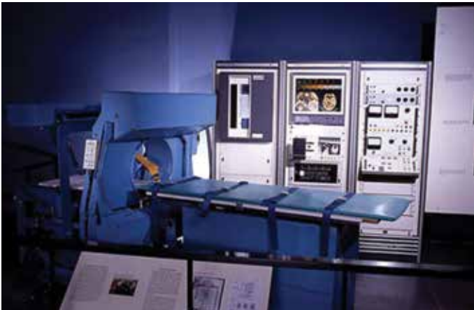
☒ АСТА Модел 010 Први КТ скенер на коме је било могуће снимање и других делове тела, осим главе
